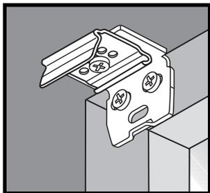
**Montáž na rám okna (pomocí stěnového úhelníku)**
